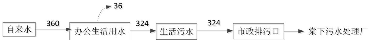
图 2-1 本项目水平衡图 (单位:  $\text{m}^3/\text{a}$ )
